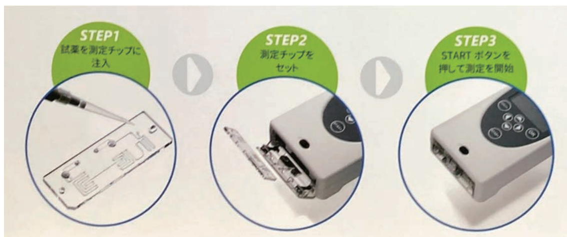
図2 検体とマスターミックスの混合物を測定チップに注入して本体をセットする手順
